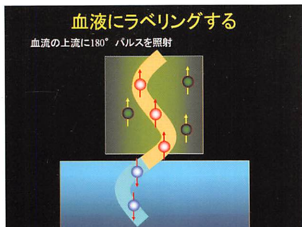
図1 関心領域の上流部分に反転パルスを照射し動脈血のスピンを反転することによりラベルする。
